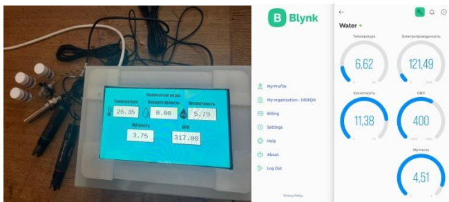
Рис. 1. Система для сбора и передачи данных совмещенных измерений.
