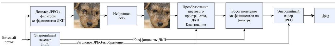
Рис. 2. Общая схема работы транскодера
