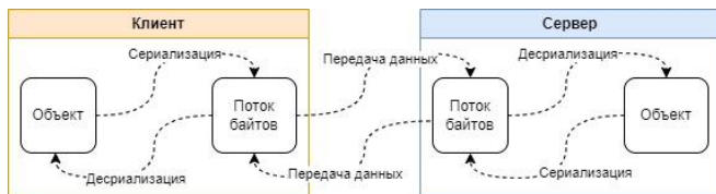
Рис. 2. Принцип обмена данными
