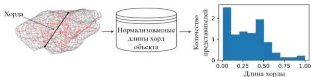
Рис. 2. Алгоритм получения гистограммы длин хорд поверхности
