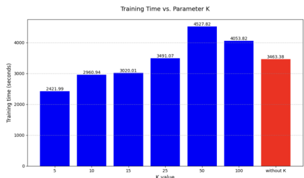
Рис. 4. Зависимость времени обучения стохастически конфигурируемой нейросети на наборе данных Signal от размера окна K
