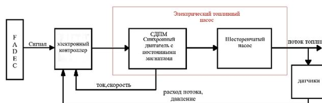
Рис. 1. Обобщенная структурная схема АЭТН
