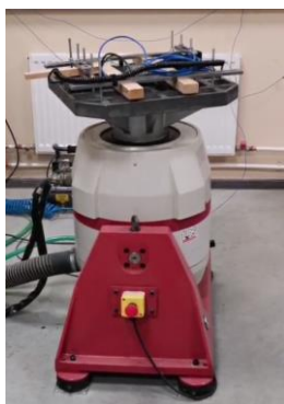
Рис. 2. Установка для тестирования виброустойчивости
