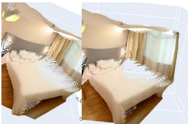
Рис. 4. Результат предсказания карты глубины трехмерной сцены без удаления и с удалением статистических выбросов
