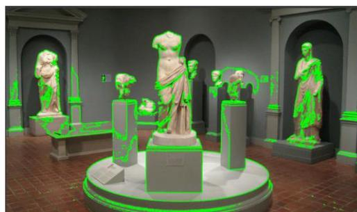
Рис. 1. Результат метода анализа градиентов изображения для определения границ контуров
